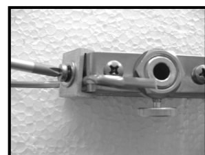
Schrauben Sie den Schweißdraht in einer der Klemmplatten fest.
