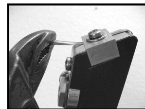
Ziehen Sie den Draht mit einer Zange und einem Schraubstock an und schrauben Sie ihn in der zweiten Klemmplatte fest.
