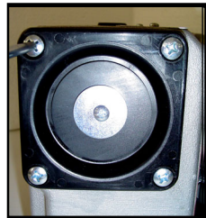
Schrauben Sie den Deckel vom Filtergehäuse
